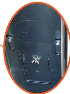
Réglage de la hauteur de la plateforme, pour installer des flacons de 500 ml à 1L.
